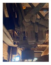
> Substituir reparos da válvula de descarga rápida.
