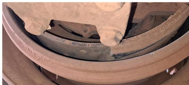
Sistemas de freios dianteiros e traseiros com desgastes, com isso sugerimos a substituição dos componentes listados abaixo por peças originais.
